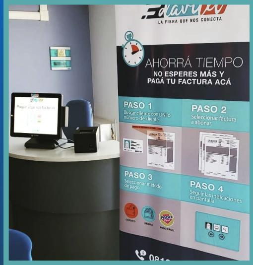
Consiste en un monitor táctil, un lector de tarjetas de banda magnética y una impresora de tickets.
